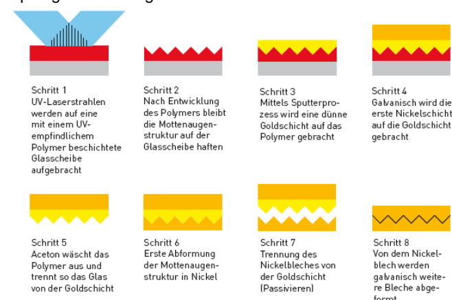
Abbildung 2 • Herstellung des Nickelbleches mit Mottenaugenstruktur
